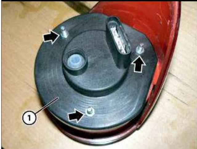
● 将盖 (1) 安装在尾灯单元上并通过拧紧指示的三个螺母进行紧固。
