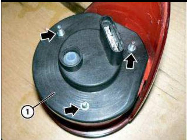
● 通过松开指示的三个螺母，拆下尾灯单元上的盖 (1)。
