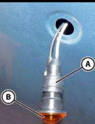
● 从侧面转向指示灯 (A) 拆下外部镜片 (B)。
