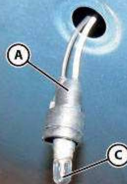
■ 从侧面转向指示灯 (A) 拆下灯 (C) 并进行更换，确保正确地安装和连接新灯。
