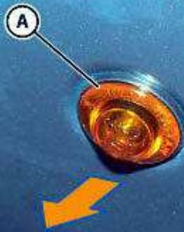
● 使用适当的工具并注意不要损坏车身，从前部翼子板撬出侧面转向指示灯 (A)。
