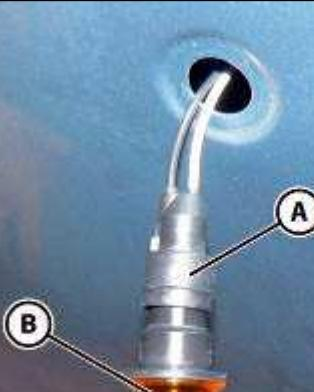
■ 将外部镜片 (B) 重新安装到侧面转向指示灯 (A) 上。
